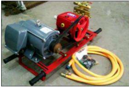
ภาพที่ จ.12 เครื่องยนต์พ่นสารแบบใช้แรงดันน้ำสูง ประเภทสองคนหามและติดตั้งล้อเข็น
