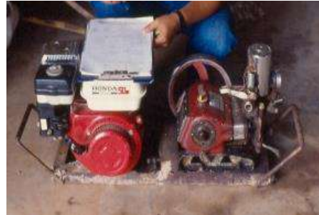
ภาพที่ จ.12 เครื่องยนต์พ่นสารแบบใช้แรงดันน้ำสูง ประเภทสองคนหามและติดตั้งล้อเข็น
