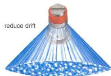
ภาพที่ จ.3 การกระจายของละอองสารจากหัวฉีดแบบแรงปะทะ
