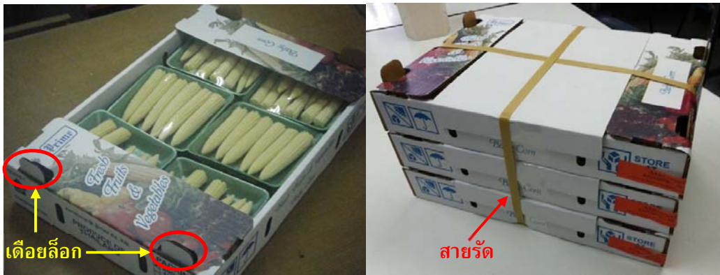
ภาพที่ ข.1 กล่องที่มีเดือยล็อกระหว่างกล่อง ทำให้กระชับขึ้นเมื่อนำกล่องมาซ้อนกัน และใช้สายรัดมัดรอบกล่องให้เป็น 1 มัด (bundle)
