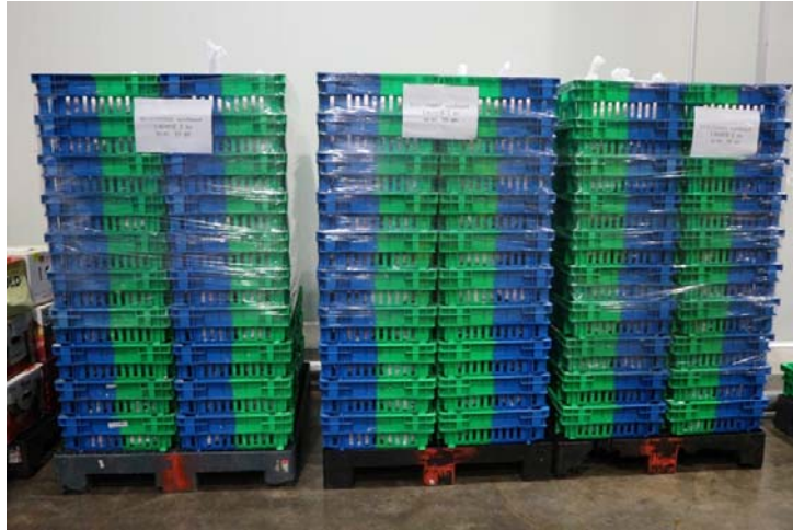
ภาพที่ ข.9 ตะกร้าบรรจุแอปเปิลที่อยู่ในถงพลาสติกที่จัดเรียงแบบซ้อนกันและหุ้มด้วยฟิล์มพลาสติกบนพาเลต เพื่อเพิ่มความแข็งแรง
