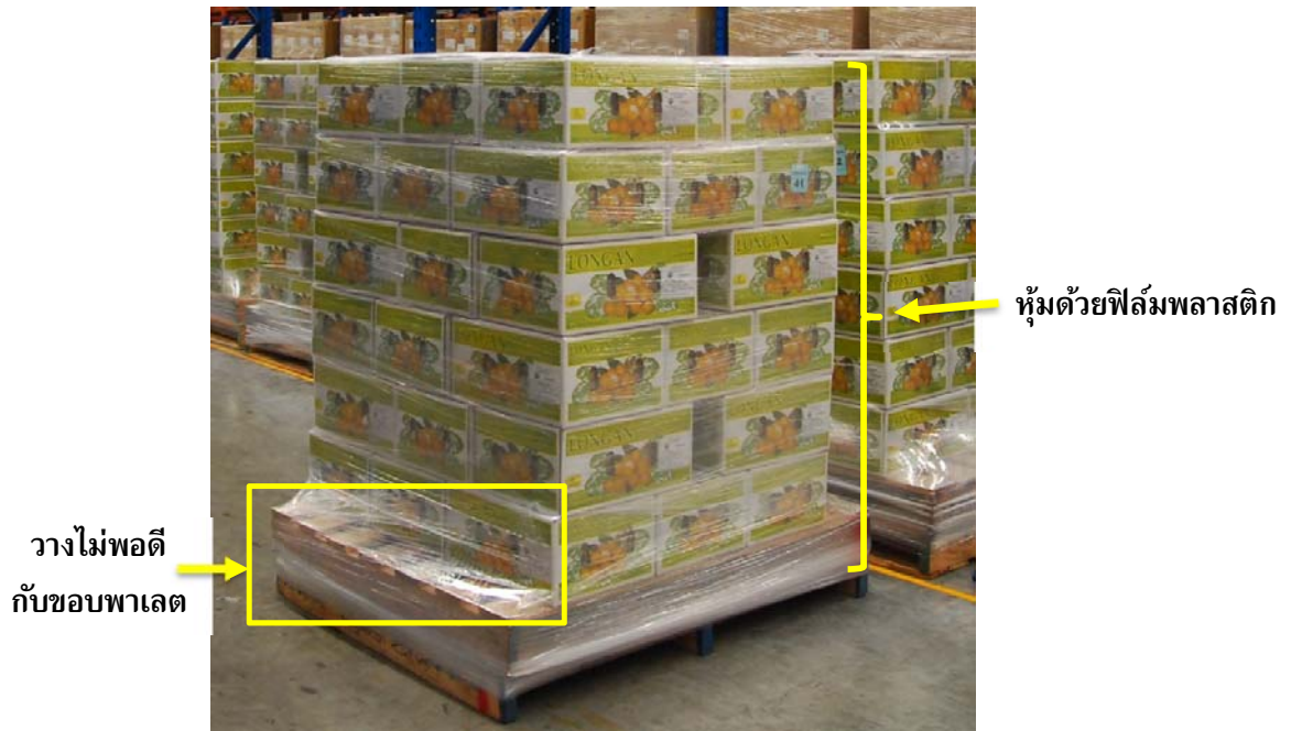
ภาพที่ ข.7 กล่องที่จัดเรียงไม่พอดีกับขอบพาเลต อาจทำให้กล่องเคลื่อนที่ได้ระหว่างการขนย้าย
