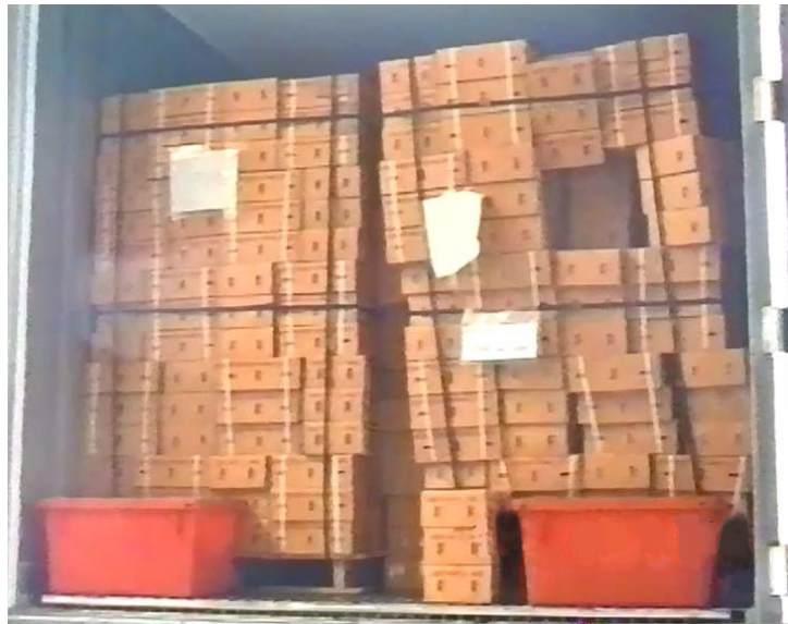
ภาพที่ ข.6 กล่องที่จัดเรียงแต่ไม่ใช้ฉากเข้ามุม ทำให้กองสินค้าล้ม และกล่องหลุดออกจากพาเลต เมื่อถึงปลายทาง
