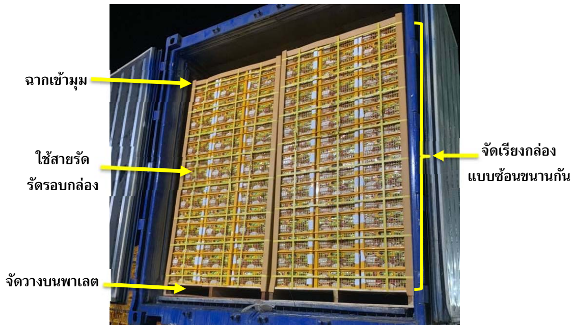
ภาพที่ ข.4 กล่องจัดเรียงแบบซ้อนขนานในพาหนะสำหรับขนส่ง ซึ่งมีฉากเข้ามุมและใช้สายรัดรัดรอบกล่อง โดยกล่องวางเสมอกับขอบพาเลท
