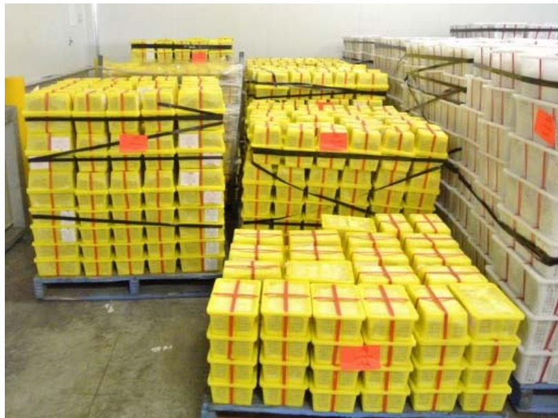
ภาพที่ ข.2 ตะกร้าบรรจุลำไยที่มีรองบนฝาสำหรับล็อกระหว่างตะกร้า และจัดเรียงแบบซ้อนกัน และมัดด้วยสายรัดบนพาเลต
